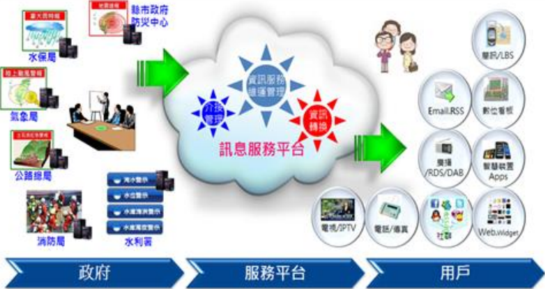
圖 2-4 防救災訊息服務平臺整體架構圖 資料來源：內政部
